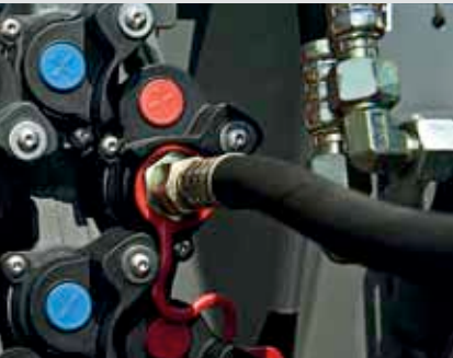
Los acoplamientos DUDK permiten que las válvulas hidráulicas se ajusten bajo presión a ambos lados; resulta fácil montar y desmontar aperos. Las aletas de válvula con cierre automático ofrecen una protección segura frente a la contaminación por suciedad o agua.
