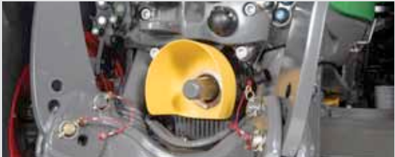
La toma de fuerza delantera integrada proporciona 1000 rpm. La línea de transmisión directa del motor al apero supone una gran eficiencia. Otra ventaja de los brazos inferiores plegables consiste en que los aperos pueden acoplarse más cerca del tractor y en que el acceso a los neumáticos delanteros es mejor.
