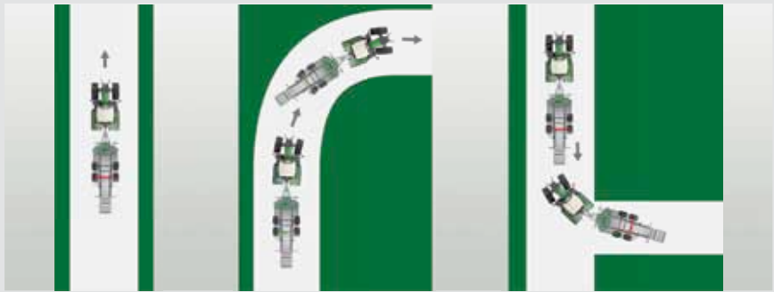
El bloqueo automático opcional del eje de la dirección desbloquea automáticamente el eje de la dirección a una velocidad predefinida en los remolques con ejes de guiado automático. En recorridos rectos, el rígido ángulo de guiado automático garantiza unas maniobras estables en todo momento. Los usuarios no necesitan bloquear el eje direccional manualmente fuera de la gama de velocidad seleccionada, ni tampoco cuando circulan marcha atrás.
