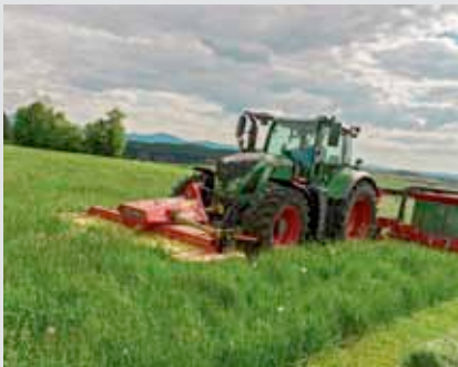
El control de descarga para el elevador delantero representa una ventaja adicional cuando se utiliza un quitanieves o una segadora delantera en operaciones de siega, ya que la guía del apero puede ajustarse con rapidez a las superficies irregulares.
