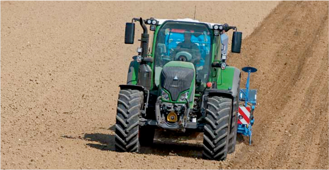
El Fendt 700 Vario le ofrece las mejores soluciones para sus necesidades individuales en tres variantes de equipamiento: Power, Profi y ProfiPlus. Tan solo la parte delantera incluye ya diversas funciones y áreas de montaje: tercer punto, hasta dos válvulas de control de doble efecto, retorno delantero sin presión, toma de siete pines, TdF delantera (1.000 rpm), elevador delantero EPC, incluido amortiguador de oscilaciones, ganchos del brazo inferior, brazos inferiores plegables, llave de corte.
