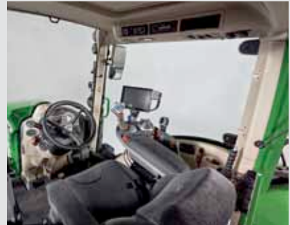
Eliminación del pilar B
