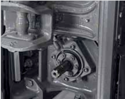
TdF trasera con velocidades 540, 540E, 1.000 y 1.000E rpm. La activación externa de la TdF en la parte trasera resulta especialmente cómoda.
