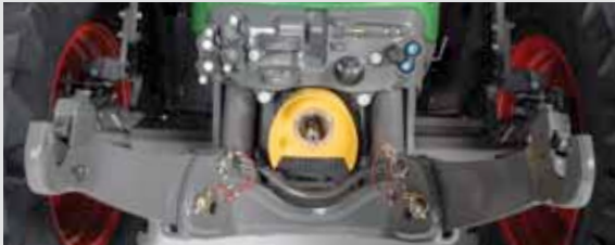
El elevador delantero está totalmente integrado en el semibastidor, por lo que es muy estable. Las bielas inferiores en el elevador delantero pueden plegarse en diagonal, ofreciendo más espacio libre para trabajar con el cargador frontal.
