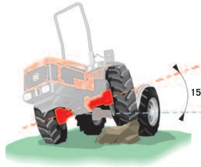
El Chasis Integral Oscilante ACTIO™ está formado por un robusto travesaño solidario con los ejes del tractor, que aloja en su interior las transmisiones delantera y trasera, con una articulación central, que puede oscilar longitudinalmente hasta 15°.
